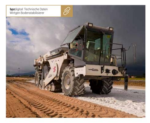
Die beiden Bodenstabilisierer vom Typ WR 2000 durchmischten den Boden unter Zugabe von Kalk und Zement, um die gewünschte Tragfähigkeit zu erzielen. Bilder: Wirtgen
