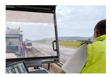
Das Nivelliersystem LEVEL PRO der Wirtgen-Fräsen entlastet die Fahrer und erhöht gleichzeitig die Qualität des Fräsergebnisses
