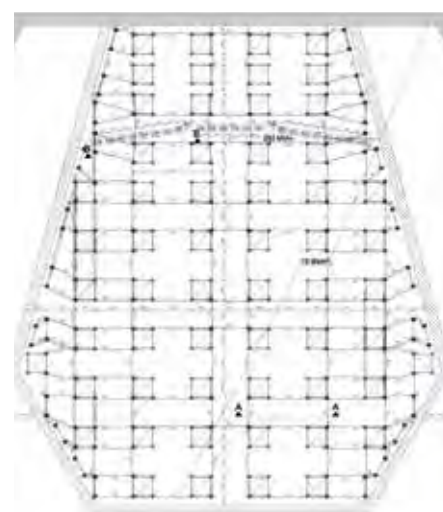
Die Hünnebeck Schalungsplaner entwickelten ein ca. 9 m hohes hexagonales Traggerüst aus 70 ID15 Türmen und 24 Lastrahmenstützen zur Herstellung des Deckenbereiches über dem Kabarett.
