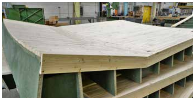
Jedes Schalungselement ist ein Einzelstück und wird bei Doka in Maisach gefertigt. Bilder: Paul Deder
