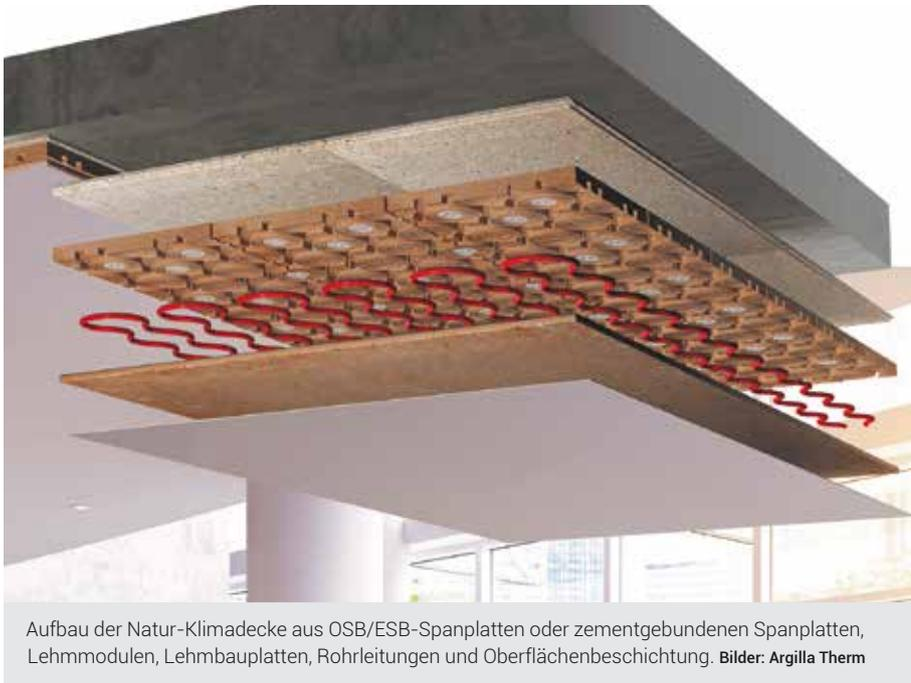
Aufbau der Natur-Klimadecke aus OSB/ESB-Spanplatten oder zementgebundenen Spanplatten, Lehmmodulen, Lehmbauplatten, Rohrleitungen und Oberflächenbeschichtung. **Bilder: Argilla Therm**
