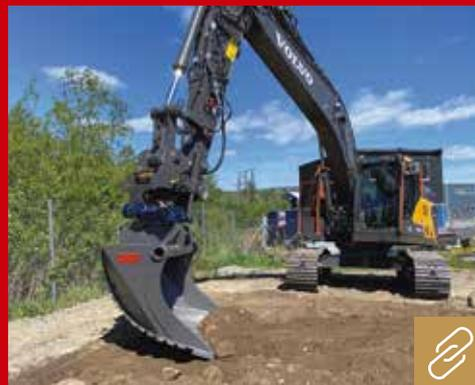
SMP Parts verfügt über ein Sortiment von 11 Tiltrotatoren für Bagger von 2 bis 30 t. Damit können Anbaugeräte unbegrenzt drehen und bis zu  $40^\circ$  in jede Richtung schwenken.
