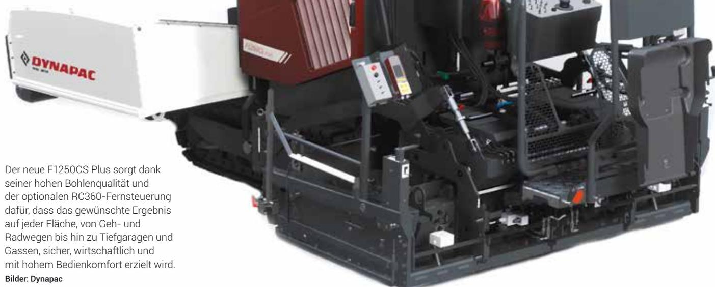
Der neue F1250CS Plus sorgt dank seiner hohen Bohlenqualität und der optionalen RC360-Fernsteuerung dafür, dass das gewünschte Ergebnis auf jeder Fläche, von Geh- und Radwegen bis hin zu Tiefgaragen und Gassen, sicher, wirtschaftlich und mit hohem Bedienkomfort erzielt wird.
